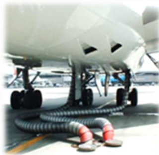
固定式GPU (左: 電力 右: 空調)
