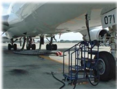
固定式GPU (左: 電力 右: 空調)
